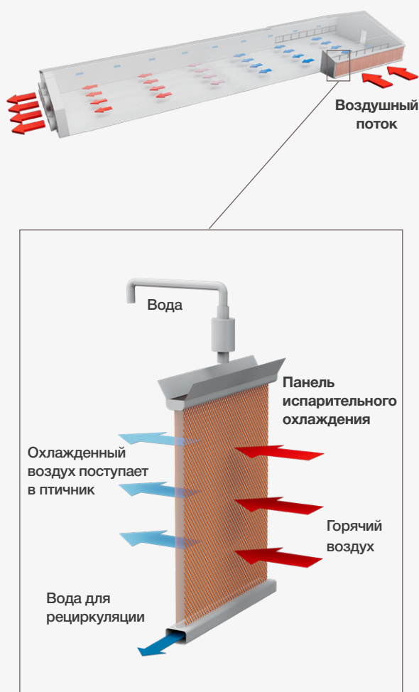
Рисунок 6.24 Работа панелей испарительной системы охлаждения с туннельной вентиляцией.
