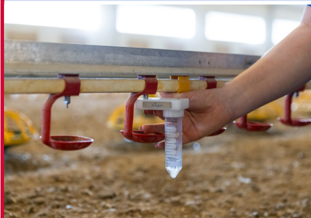
Рисунок 5.6 Измерение напора воды в ниппельной линии поения.
